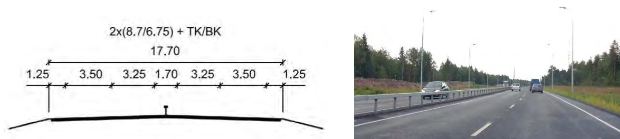
Kuva 28. Nykypaikalle parannettavan kapean keskikaiteellisen nelikaistatien poikkileikkaustyyppi (Lähde Liikenneviraston ohjeita 29/2013).
