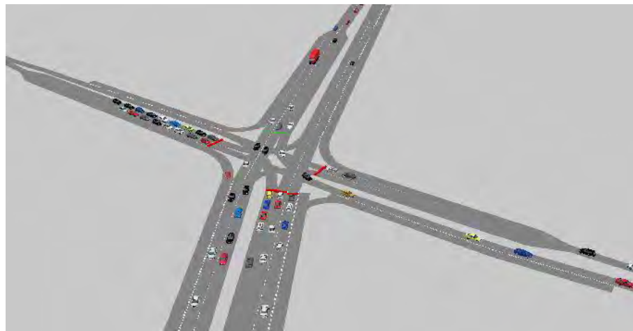
Kuva 23. Limingantien parannetun liikennevaloliittymän vuoden 2030 iltahuipputuntiliikenteen simulointi-ilanne. Lähde: Ramboll Oy.
