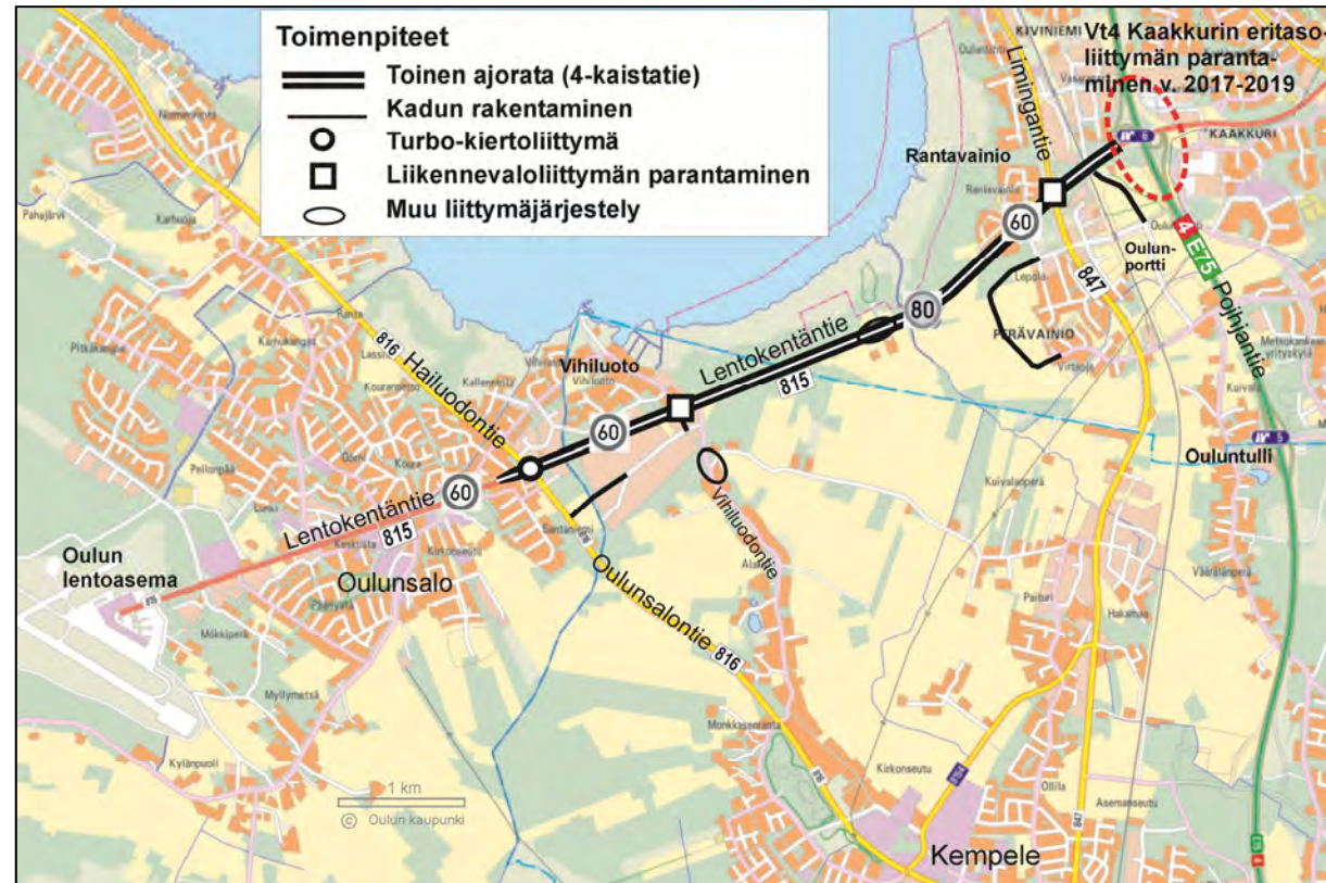
Kuva 14. Vaihtoehto VE 1; nelikaistainen Lentokentäntie ja tasoliittymät.
