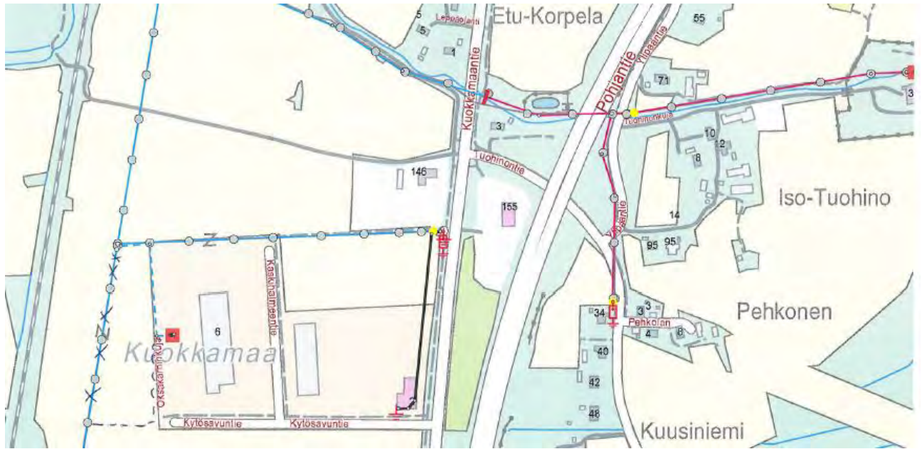
Kuvat 27. Ote olemassa olevasta sähköverkosta alueella / OSS.
