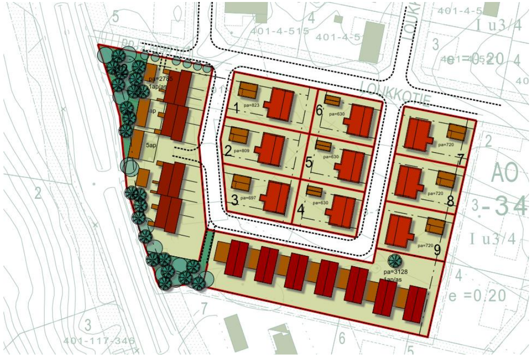
Kuva 11. Kiertokadun, "Loukkokierron" varteen rakentuva rakennemalli VE4. Rakennemallissa lähinnä Kokkokankaan tietä osoitettiin rivitaloja ja alueen eteläosaan kytkettyjä pientaloja. Myös tässä mallissa alueella sijaitseva kuusi on esitetty säilytettäväksi ja kevyen liikenteen pääsy Kokkokankaantielle alueen lounaisnurkasta.
