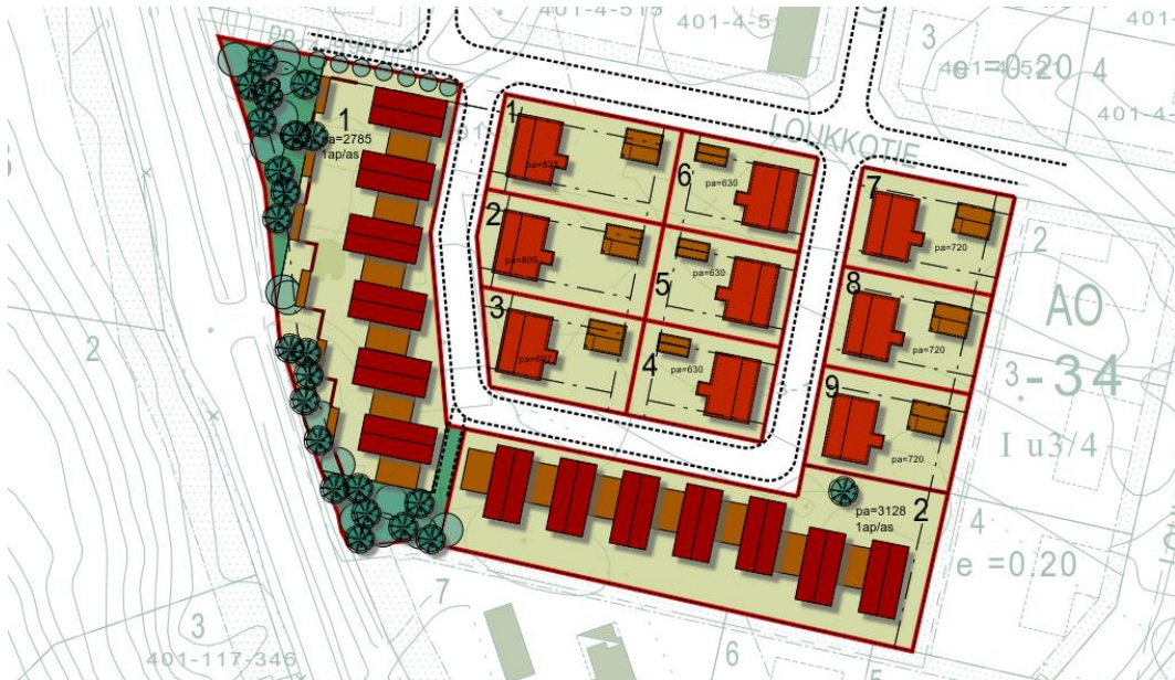
Kuva 12. Kiertokadun, "Loukkokierron" varteen rakentuva rakennemalli VE3. Rakennemallissa lähinnä Kokkokankaan tietä osoitettiin rivitalojen paikalle kytkettyjä pientaloja. Muuten malli on, kuten rakennemalli VE4.
