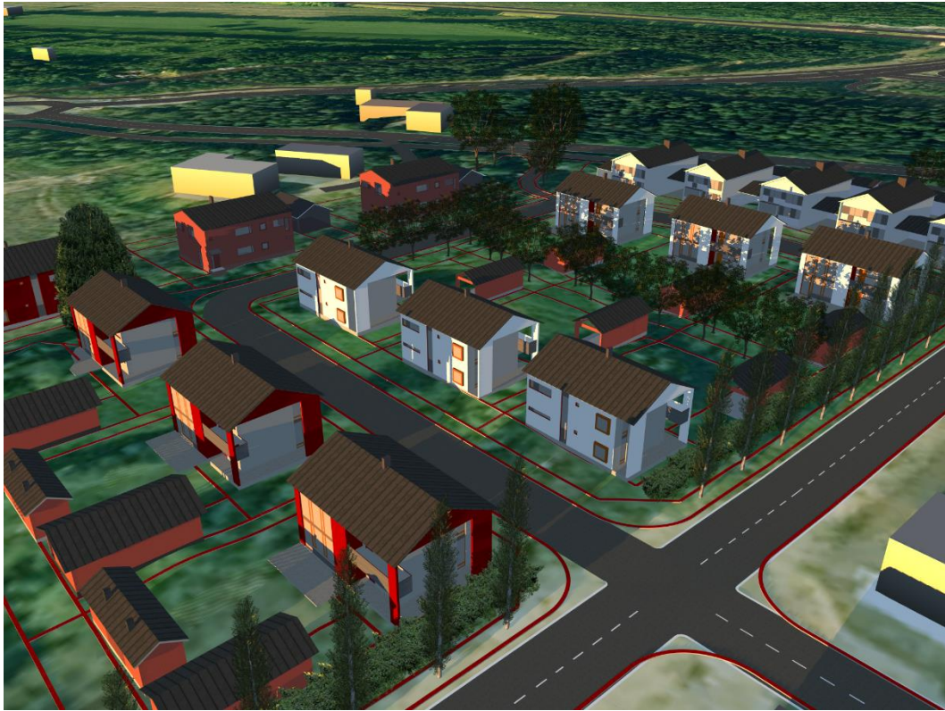
Kuva 16. Aluerakenne nähtynä yläviistosta kaakosta. Punaisina viivoina näkyvät kortteli-, tontti- ja rakennusalueiden rajat. Rakennukset pakotetaan rakennettaviksi kadun varteen nuolimerkinnoin, jotta alueelle saadaan muodostumaan riittävän yhtenäisiä viherpiha-alueita, eikä tarpeettomasti varjosteta naapuritontteja. Rakennusten sijoittelulla kadun varteen saadaan myös katutilan rakenne ehyeksi.
