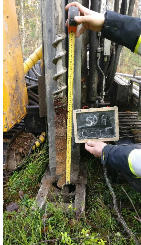
Kuva 40. Näyte S04 syvyys 0,0-0,5 m (13.10.2020).
