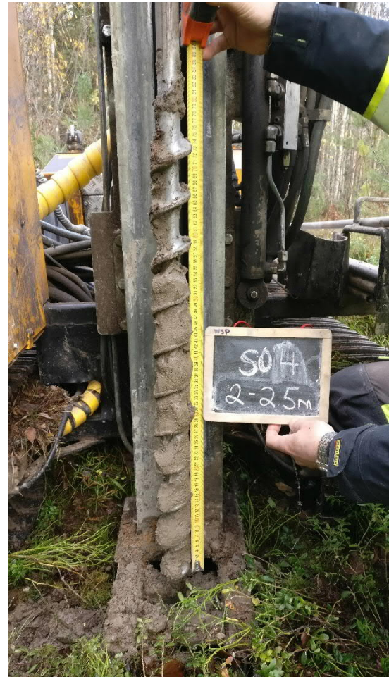
Kuva 49. Näyte SO4 syvyys 2,0 -2,5 m (13.10.2020).
