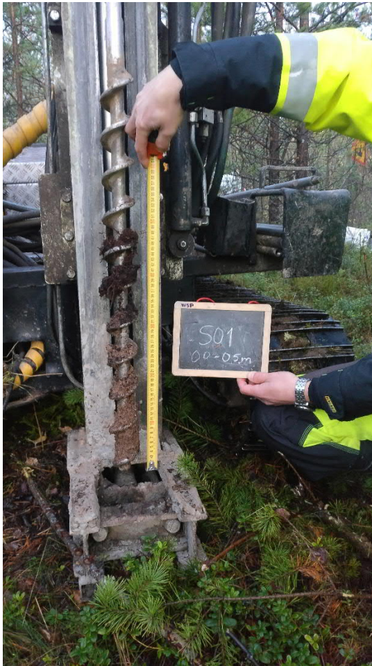
Kuva 1. Näyte SO1 syvyys 0,0-0,5 m (13.10.2020).
