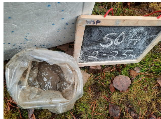
Kuva 50. Näyte SO4 syvyys 2,0 -2,5 m (13.10.2020).
