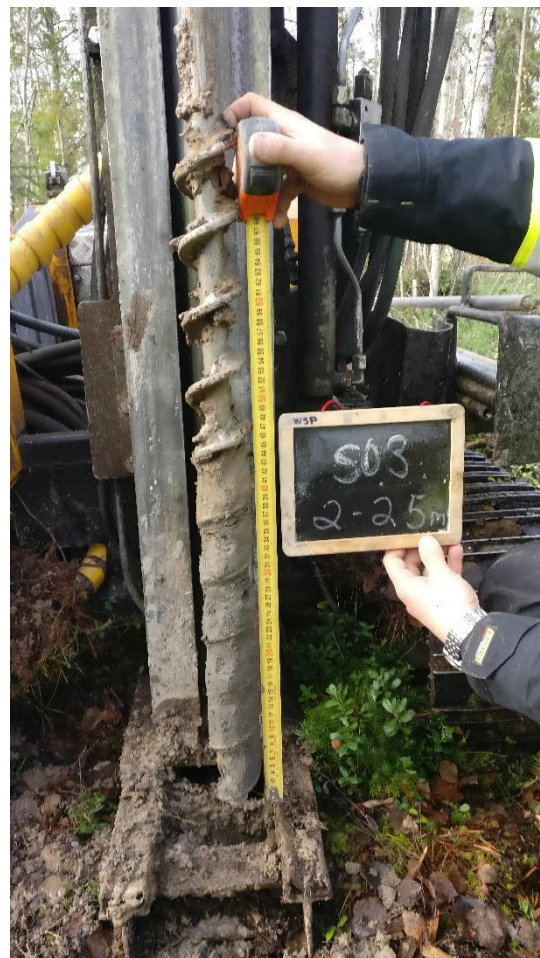
Kuva 33. Näyte S03 syvyys 2,0-2,5 m (13.10.2020).
