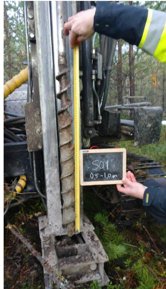
Kuva 3. Näyte SO1 syvyys 0,5-1,0 m (13.10.2020).
