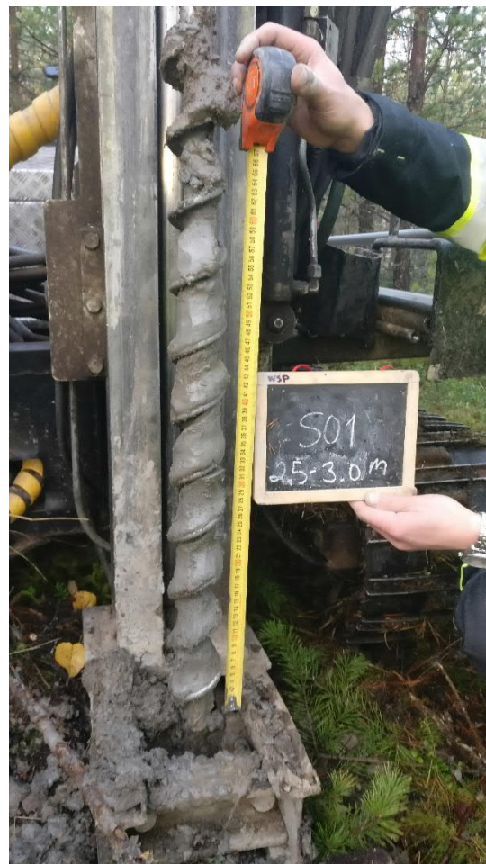
Kuva 10. Näyte S01 syvyys 2,5-3,0 m (13.10.2020).
