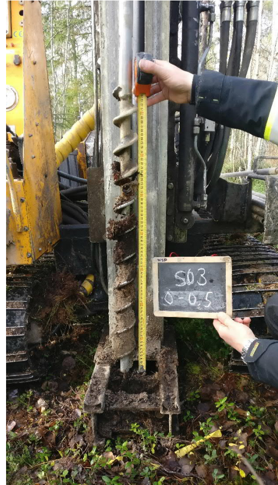
Kuva 25. Näyte SO3 syvyys 0,0-0,5 m (13.10.2020).
