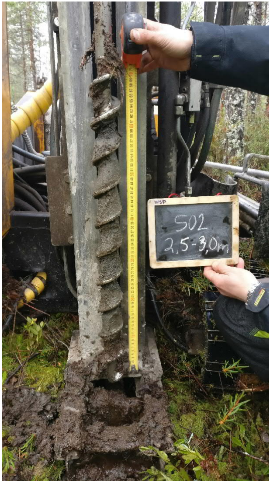
Kuva 20. Näyte S02 syvyys 2,5-3,0 m (13.10.2020).
