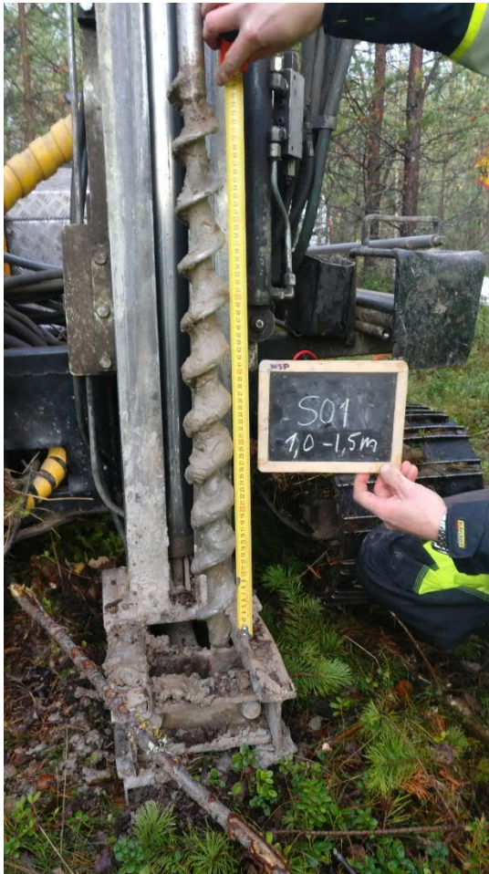
Kuva 4. Näyte SO1 syvyys 1,0-1,5 m (13.10.2020).
