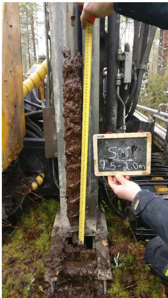
Kuva 17. Näyte SO2 syvyys 1,5-2,0 m (13.10.2020).
