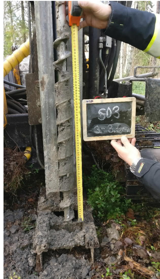
Kuva 36. Näyte S03 syvyys 3,0-3,5 m (13.10.2020).
