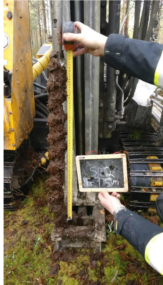
Kuva 16. Näyte SO2 syvyys 1,0-1,5 m (13.10.2020).
