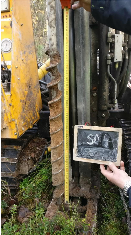
Kuva 42. Näyte SO4 syvyys 0,5-1,0 m (13.10.2020).
