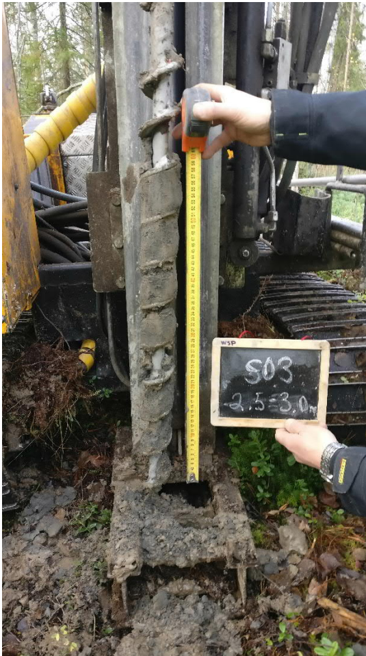
Kuva 35. Näyte S03 syvyys 2,5-3,0 m (13.10.2020).
