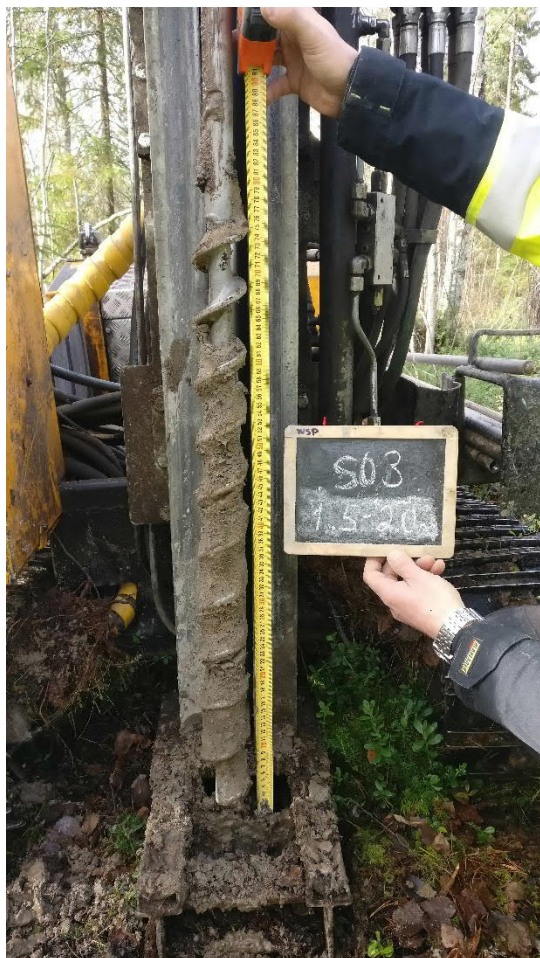
Kuva 31. Näyte S03 syvyys 1,5-2,0 m (13.10.2020).
