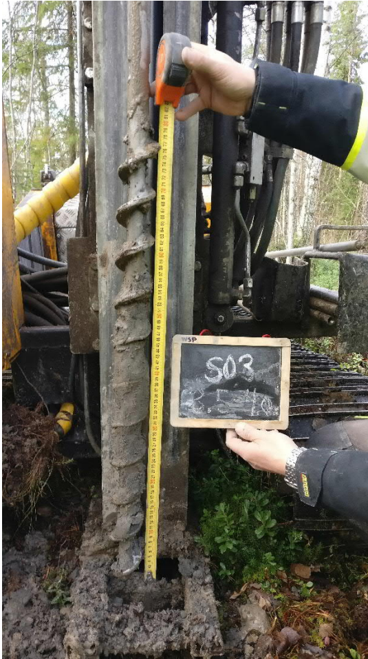
Kuva 38. Näyte S03 syvyys 3,5-4,0 m (13.10.2020).
