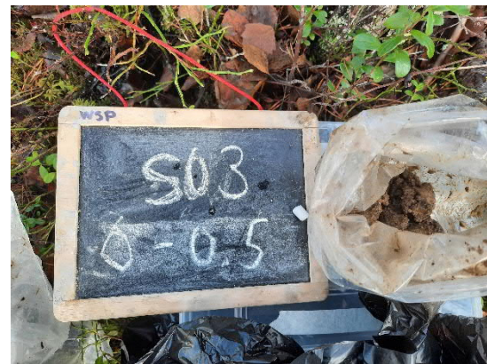
Kuva 26. Näyte SO3 syvyys 0,0-0,5 m (13.10.2020).
