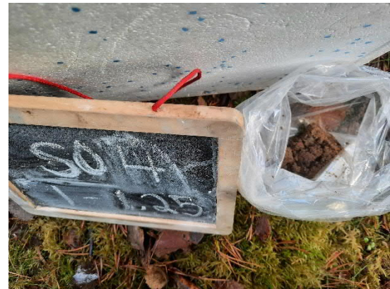
Kuva 45. Näyte SO4 syvyys 1,0-1,25 m (13.10.2020).
