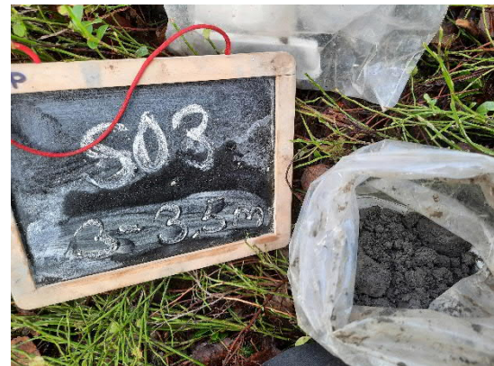
Kuva 37. Näyte S03 syvyys 3,0-3,5 m (13.10.2020).
