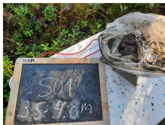
Kuva 13. Näyte S01 syvyys 3,5-4,0 m (13.10.2020).
