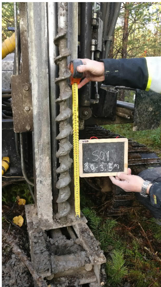
Kuva 12. Näyte S01 syvyys 3,0-3,5 m (13.10.2020).
