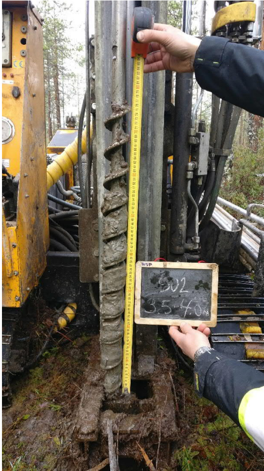
Kuva 23. Näyte SO2 syvyys 3,5-4,0 m (13.10.2020).
