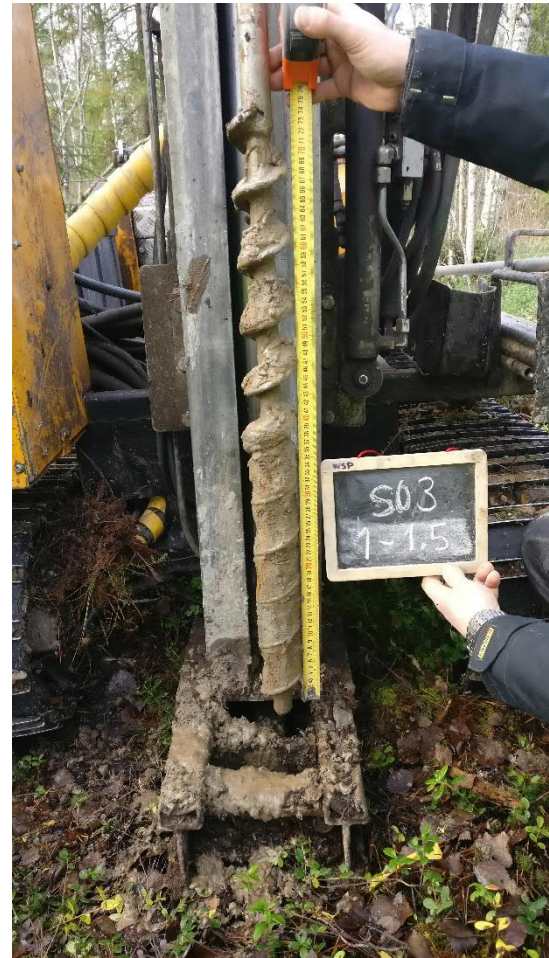
Kuva 29. Näyte S03 syvyys 1,0-1,5 m (13.10.2020).
