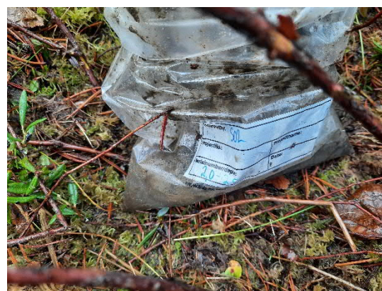
Kuva 19. Näyte SO2 syvyys 2,0-2,5 m (13.10.2020).
