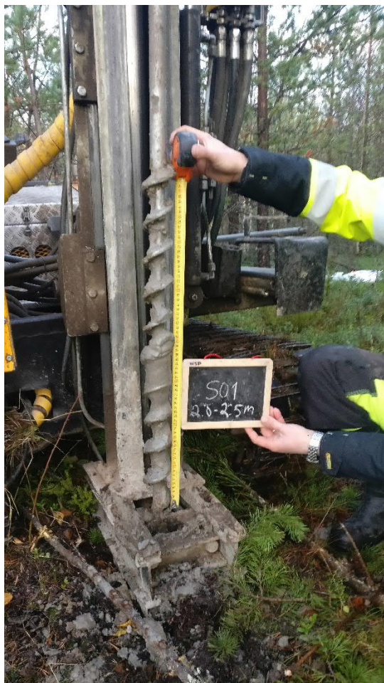
Kuva 8. Näyte S01 syvyys 2,0-2,5 m (13.10.2020).
