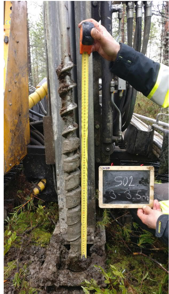
Kuva 21. Näyte S02 syvyys 3,0-3,5 m (13.10.2020).
