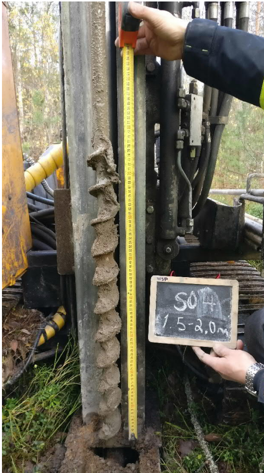
Kuva 47. Näyte SO4 syvyys 1,5 -2,0 m (13.10.2020).
