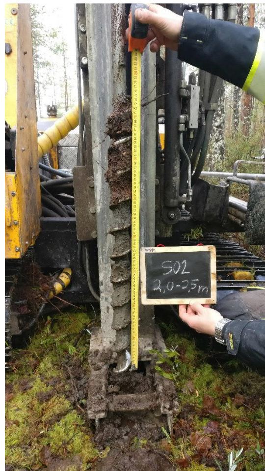
Kuva 18. Näyte SO2 syvyys 2,0-2,5 m (13.10.2020).
