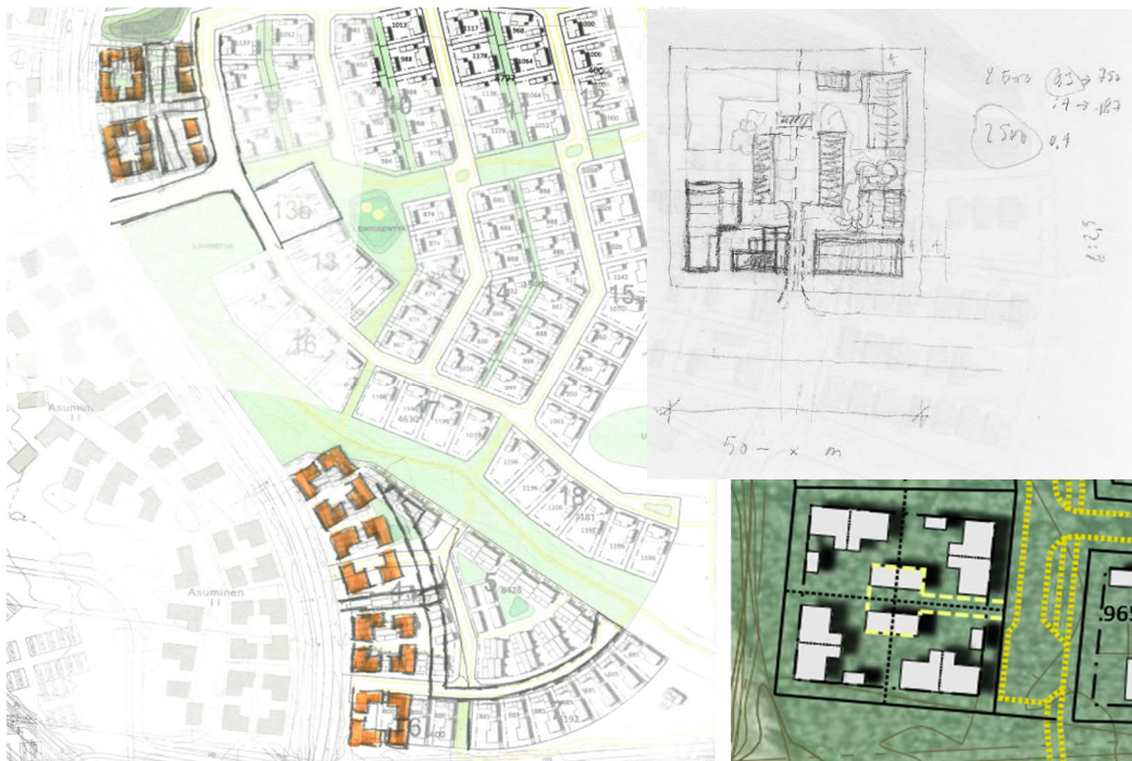
Kuva 14. Linnakaarron varren korttelirakennetta tarkistettiin vastaamaan Zeniitin viitesuunnitelman rakennetta. Korttelimallissa alue jaettiin 50x50 m yksiköihin, mikä mahdollistaa toteutuksen joko erillispientaloina, paritaloina tai pienkerrostaloina. Kaavarunkomallissa on esitetty paritaloratkaisu.
