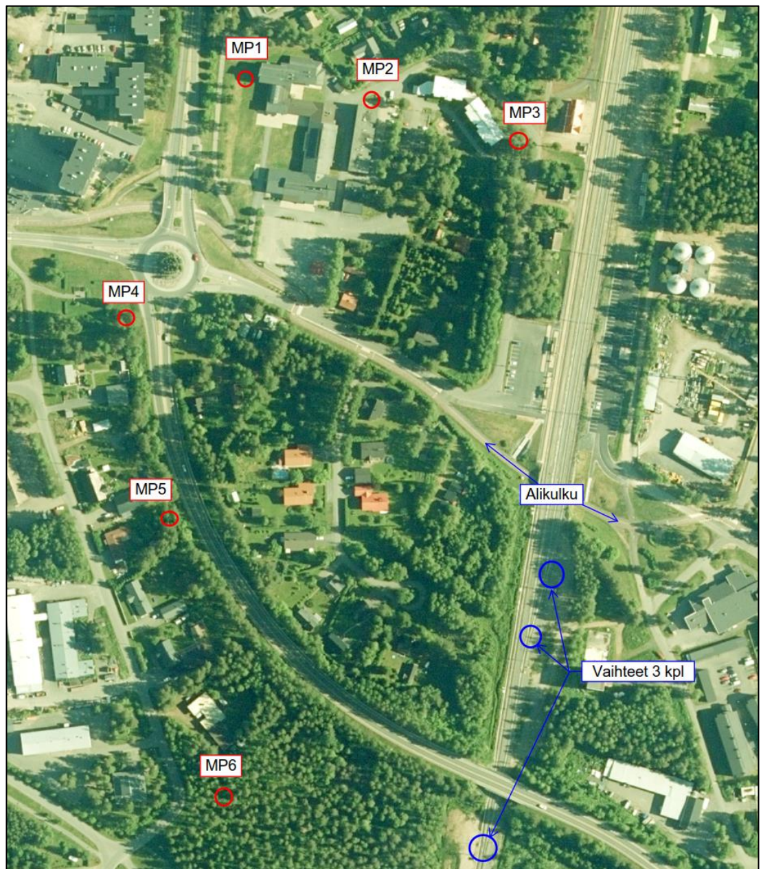
Kuva 5.1. Mittauspisteiden, alikulun ja vaihteiden sijainnit. Kaikissa mittauspisteissä mitattiin värähtelyä kolmeen suuntaan. Lähin mittauspiste (MP3) oli noin 50 metrin etäisyydellä lähimmän raiteen keskilinjasta. (Kuva: GTK Maankamara 2019)
