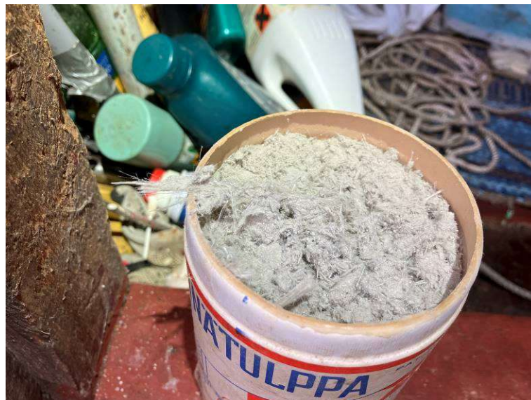
Kuva 6. Purkki on täynnä lähes puhdasta asbestia.
