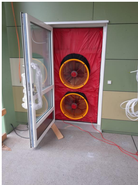
Kuva 10. Tiiveysmittaus suoritettiin kohteessa 5.9.2023. Kohteen tiiveysmittausluokitukseksi saatiin A (alle 0,6) ja ilmanvuotoluukuksi qE_{50} = 0,3 , joten tulos on erinomainen. Raportin mukaisesti "Saatujen tutkimustuloksien mukaan rakennuksen ulkovaipan ilmatiiveys on todella hyvällä tasolla". Kohde mitattiin sen laajuuden vuoksi kahdella Retrotec- laitteistolla, jotka näkyvät kuvassa. Laitteistoilla luotiin 50 Pascalin alipaine kohteeseen.
