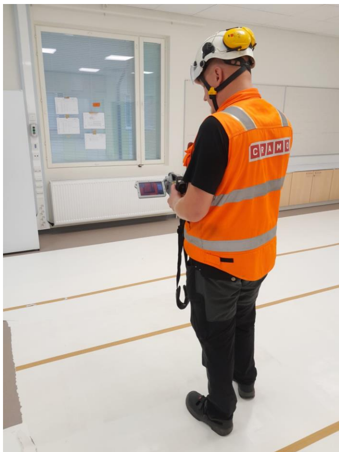
Kuva 11. Ilmavuotojen paikannusta lämpökameralla. Paikannuksissa ei havaittu merkittäviä ilmavuotoja.
